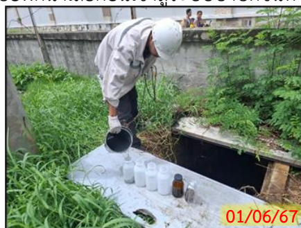
บ่อพักน้ำทิ้งที่ออกจากถังตกตะกอนก่อนระบายออกสู่ภายนอกโครงการ
