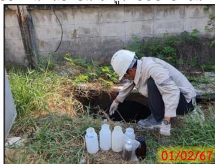
บ่อพักน้ำทิ้งที่ออกจากถังตกตะกอนก่อนระบายออกสู่ภายนอกโครงการ
